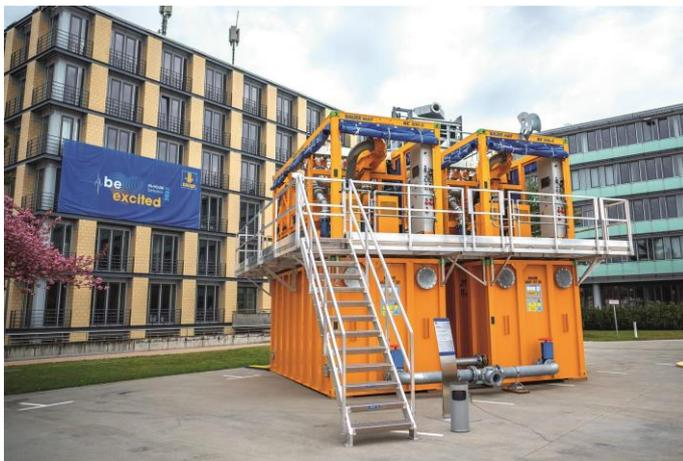
(7) Die Entsandungsanlage BE 600-C von BAUER MAT Slurry Handling Systems kombiniert zwei BE 300-C Anlagen.
